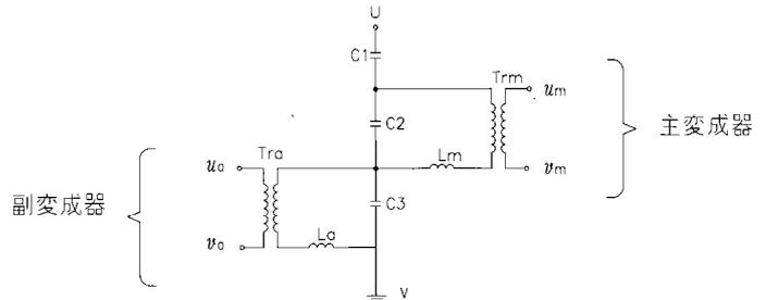
主変成器：CVTの主負担が接続される側の変成装置です。
