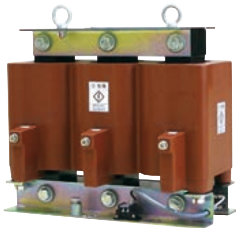
HMD-EHA形 (コイル一体形) 6.6kV回路 50Hz 53.2kvar用 L=6%
